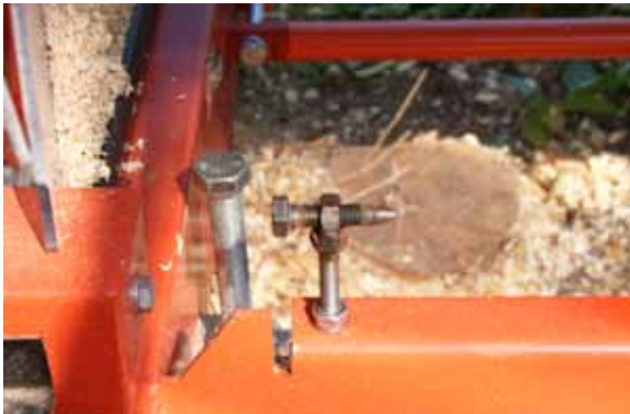
Zum Anschrauben der Klemme werden die vorhandenen Löcher der Bettschienen benutzt.
