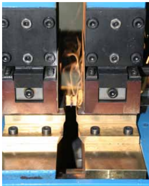
Beim Abbrenn-Stumpfschweiß-Verfahren werden die beiden Band-Enden miteinander „verschmolzen“
