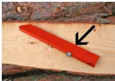
Damit auch die gedrehte Seitenstütze eingestellt werden kann, muss ein M10 Gewinde geschnitten werden.
