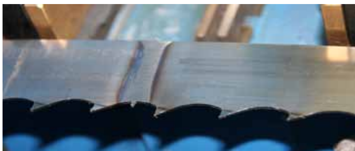
Bei der glattgeschiffenen Naht werden zum Schluss noch die Überschüsse aus dem Zahngrund und vom Bandrücken entfernt.
