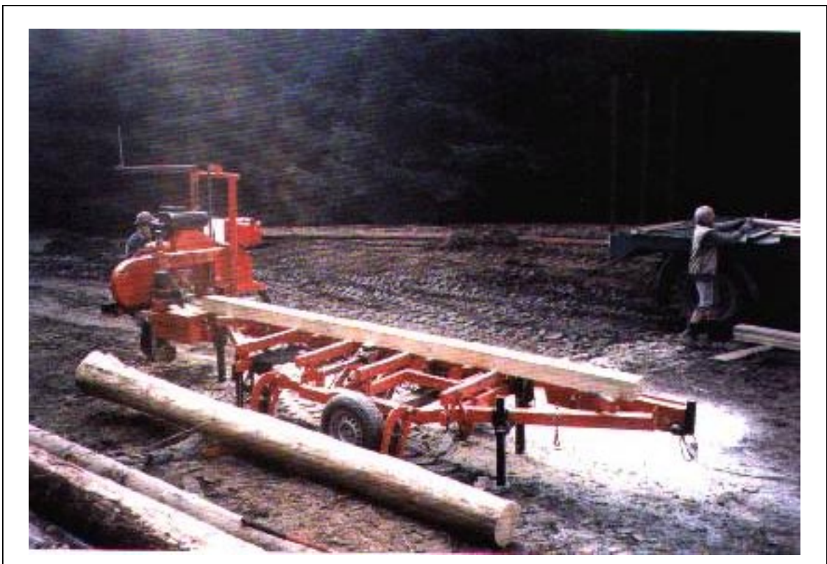
Bild 1: Mobile Bandsäge LT 30 HD in Arbeitsstellung
