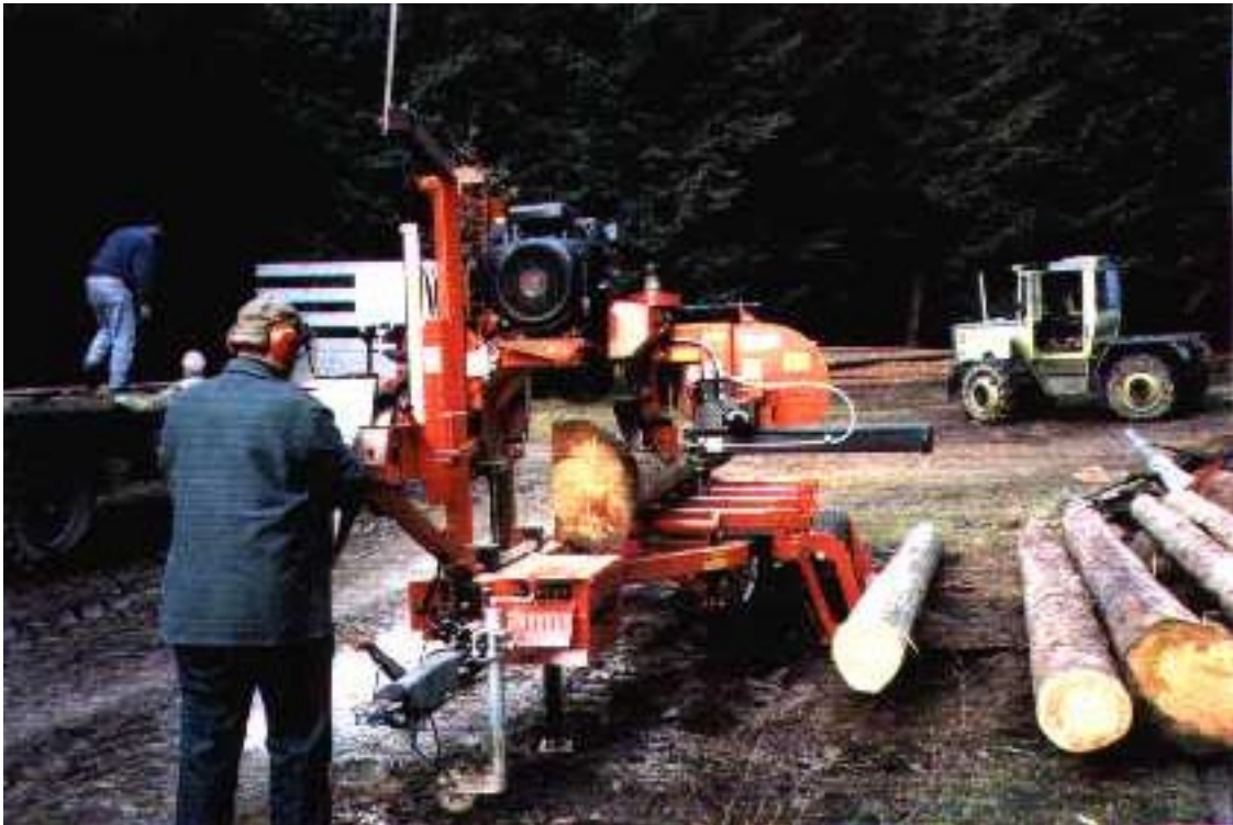
Zuschneiden einer weiteren Stammseite
