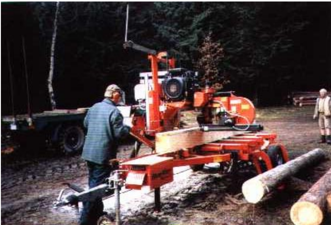
Sägen des entstandenen Kantholzes in Bretter
