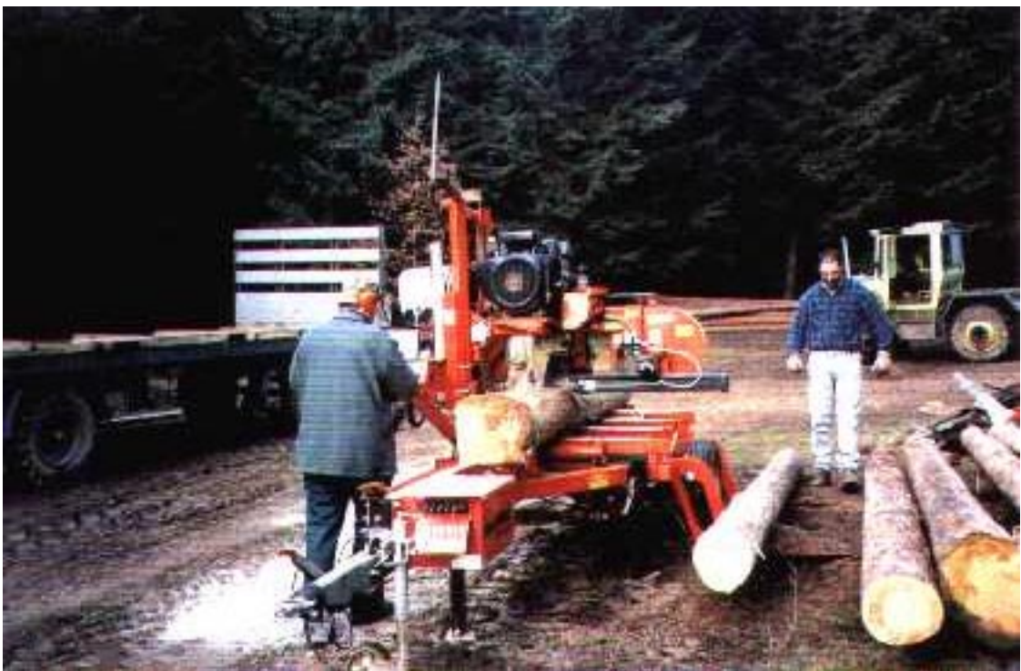
Zuschneiden der Stammunterseite
